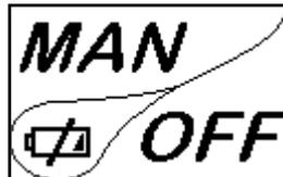
Dès que le niveau de batterie ne permet en aucune sorte la communication radio, la telecommande affiche plein ecran entier l'image de la batterie dechargee, en bloquant toute les fonctions de la telecommande tactile jusqu'a l'effective substitution des batteries.
