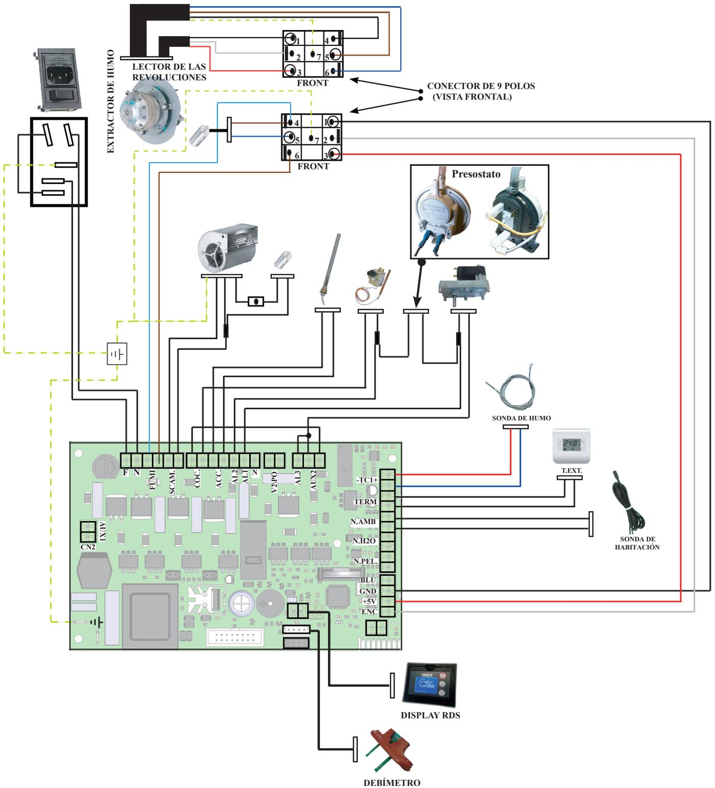
**Esquema eléctrico estufas con canalización individual**
