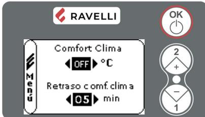
Para activar el Confort Clima, programar un valor diferente de OFF utilizando los botones 1 y 2. Confirmar por OK.
