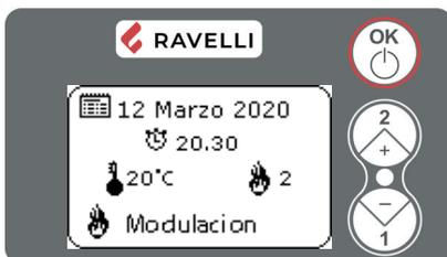
Se activa la fase de modulación, porque se ha alcanzado la temperatura del set ambiente. Si la temperatura es mantenida para todo el tiempo del "RETRASO COMFORT CLIMA" programado la estufa se apaga.
